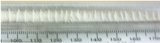
Рис. 3 Фотография периодических структур внутри прозрачной полости звукового генератора Гартмана.
