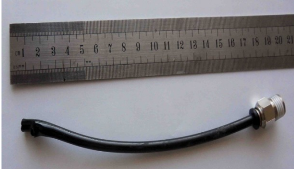
Рис.5 Прорванный участок полиэтиленовой трубки
