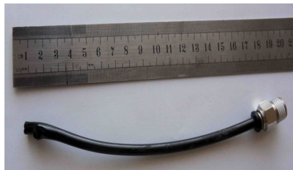
Рис. 5 Прорванный участок полиэтиленовой трубки.
